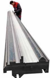
一种新的解决方案 COMPOSITAL 由树脂花岗岩 沥青混合料填充焊接钢套管,许可证:
