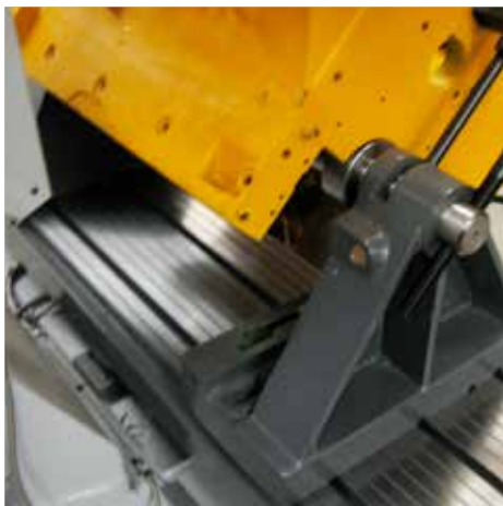
Universal fixture system for V-engine with 45° reference square Supporto universale motori a V completo di squadra a 45°
